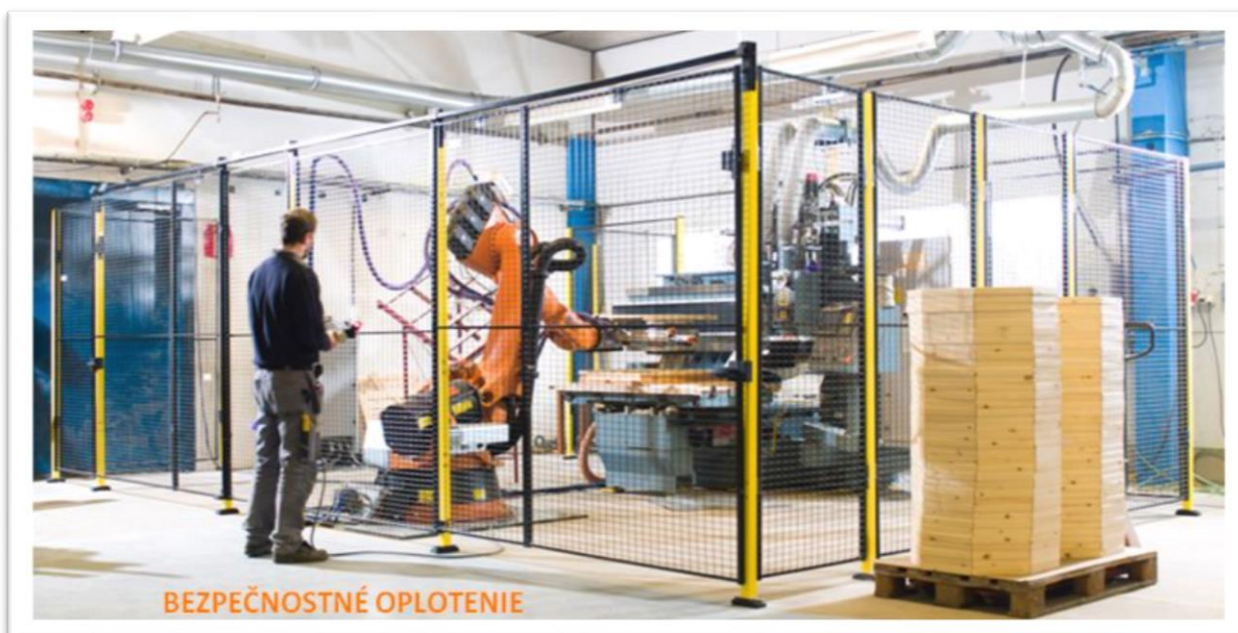
Obrázok č. 13 Príklad bezpečnostného oplotenia robotického pracoviska
