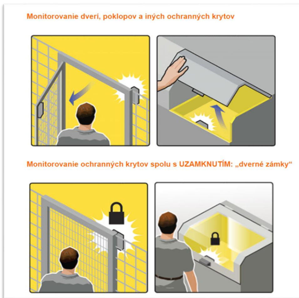
Obrázok č. 14 Dverný bezpečnostný zámok a monitorovanie vstupu
